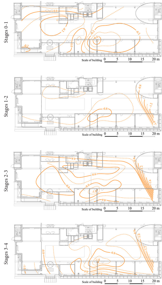
Fig. 7. Graphical visualization of height changes between neighbouring stages of geodetic measurement Rys. 7. Graficzna wizualizacja zmian wysokości pomiędzy sąsiednimi etapami pomiaru geodezyjnego
