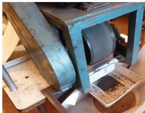
Rys. 13 Separator magnetyczny – odbiór materiału diamagnetycznego Fig. 13 Magnetic separator – collection of diamagnetic material
