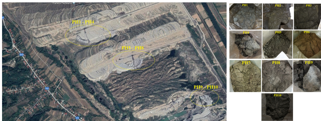
Fig. 7. Sampling points – waste dump Rys. 7. Punkty poboru próbek – składowisko odpadów
