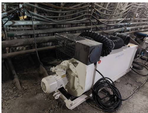
Rys. 5. Odpylacz suchy podczas badań w LW „Bogdanka” Fig. 5. Dry deduster during tests at LW "Bogdanka"
