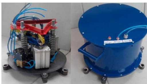
Rys. 1. Zdjęcia prototypu niekomercyjnego wzbudnika WZB Typ 1 w systemie INGEO Fig. 1. Photos of non-commercial seismic source prototype WZB Type 1 as a part of INGEO system
