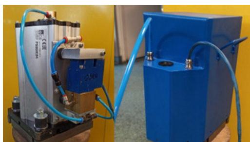
Rys. 2. Zdjęcia prototypu zoptymalizowanego wzbudnika WZB Typ 2 z płytą udarową i obudową Fig. 2. Photos of the optimized seismic source prototype WZB Type 2 with an baseplate and steel case
