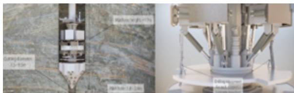
Fig. 16. Shaft Boring Machine for Shaft Enlargement Rys. 16. Wytaczarka wałkowa do powiększania wału
