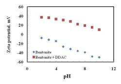
Fig. 2. Zeta potential of bentonite before and after adsorption of polymer in 0.01 M NaCl solution (at 10 mg/L polymer concentration) Rys. 2. Potencjał Zeta bentonitu przed i po adsorpcji polimeru w 0,01 M roztworze NaCl (przy stężeniu polimeru 10 mg/L)
